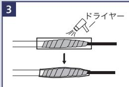
自己融着テープの上から収縮チューブで全体をカバーします。工業用ドライヤーで収縮チューブに熱風をあてて、密着させてください。（※収縮チューブはコネクタを接続する前に、予めチューブライトに通しておいてください。）
