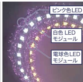
ピンク色LEDの上から白色LEDモジュールと電球色LEDモジュールを配置して、肌の色を自然に明るく照らします。
