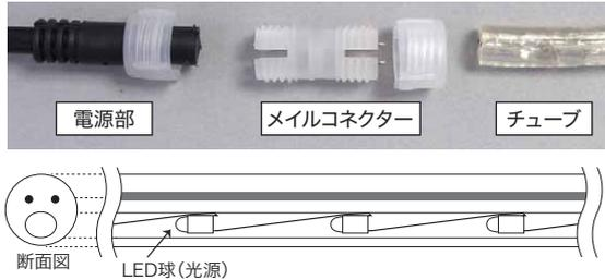
2線のチューブライトは、メールコネクタを差し込む向きが決まっています。LED球（光源）が向いている側にメールコネクタを差し込みます。（※差し込んでも点灯しない場合は、反対側から差し込んでください。）
