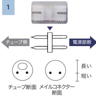
メールコネクタの締め付け用のキャップをあらかじめチューブに通してから、メールコネクタの2ピン（先が尖っている方）をチューブの2線の電線に差し込みます。
