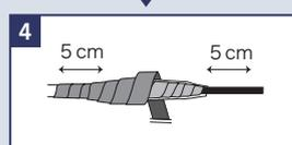
最後に収縮チューブ全体をビニールテープで巻きつけてください。その際収縮チューブの両端からライト側に5cm以上、コード側に5cm以上巻きつけてください。
