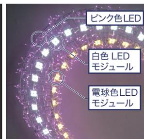
ピンク色LEDの上から白色LEDモジュールと電球色LEDモジュールを配置して、肌の色を自然に明るく照らします。
