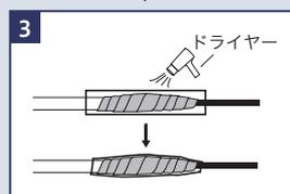
自己融着テープの上から収縮チューブで全体をカバーします。工業用ドライヤーで収縮チューブに熱風をあてて、密着させてください。（※収縮チューブはコネクターを接続する前に、予めチューブライトに通しておいてください。）
