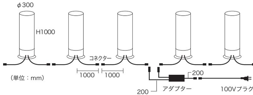
※5連結の場合、電源は必ずアクリル管3本と2本の間に設置してください。
