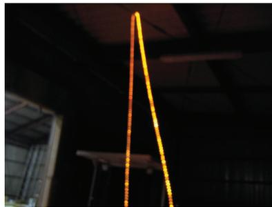
LEDチューブライトは見る方向により光の強さが変わりますのでご注意ください。（特にチューブを折り返して設置の際はご注意ください。）
