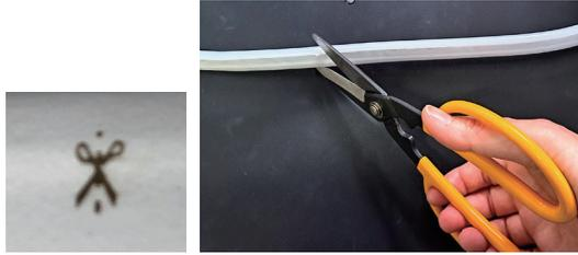
ニッパーや工具用ハサミでカットマーク部分（ハサミマーク）を切断してください。カットマークは50cmごとに記されています。カットマーク以外の部分を切断した場合は使用できなくなります。
