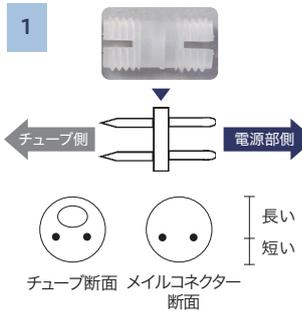
メイルコネクターの締め付け用のキャップをあらかじめチューブに通してから、メイルコネクターの2ピン（先が尖っている方）をチューブの2線の電線に差し込みます。
